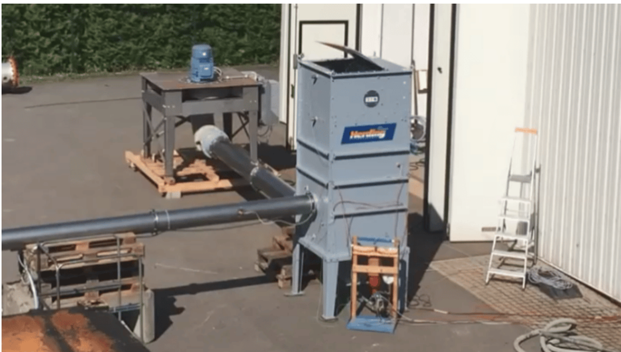
Abb.: Bild 7 flammenlose und rauchfreie Druckentlastung mit dem Herding Sinterlamellenfilter
