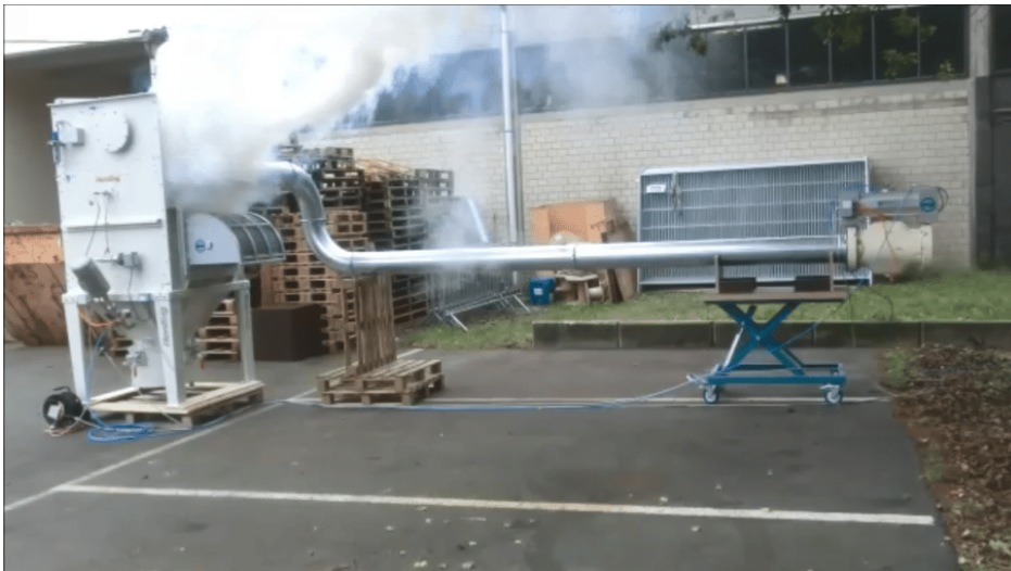
Abb.: Bild 6 flammenlose Druckentlastung
