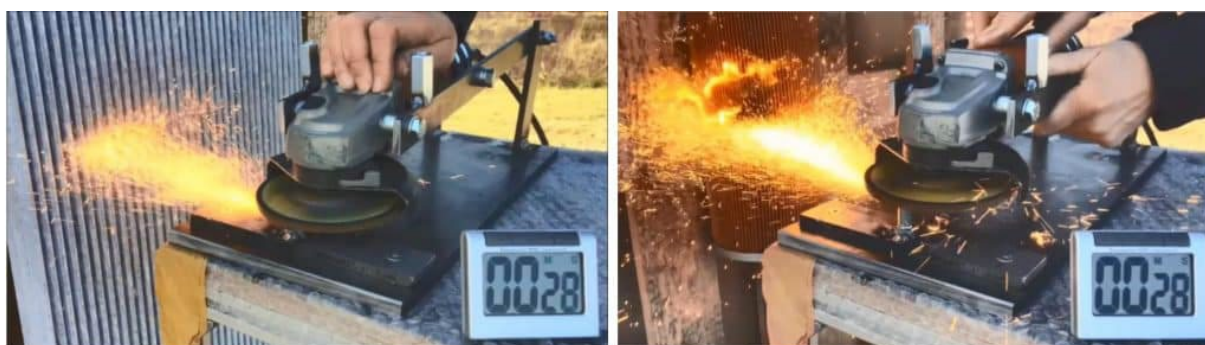
Abb.: Bild 4 Entzündbarkeit , hier Herding Sinterlamellenfilter im Vergleich zu Patronenfilter
