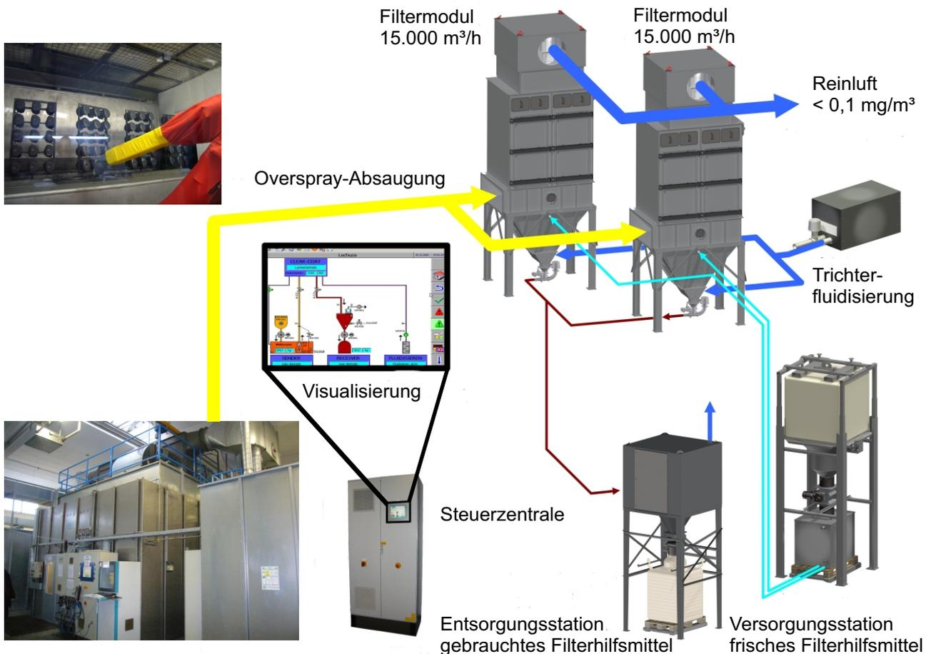
Abb.3: Realisierte Trockenabscheidung von Nasslacken
