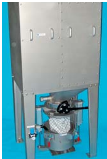
Das Filtergerät mit Sinterlamellenfilter eignet sich bei der Maßnahme der Volumenbegrenzung für toxische und nicht toxische Stäube
